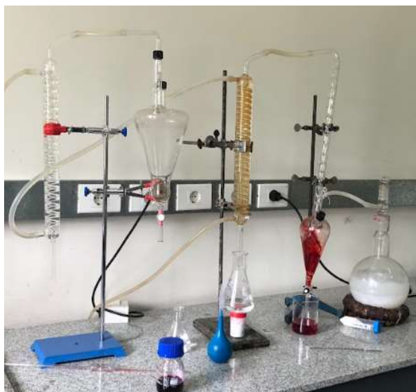
Figura 8. Determinación de acidez volátil mediante destilación por arrastre de vapor de agua.
