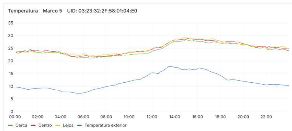
(b) Gráfica de temperatura del Marco 5 (UID: 03:23:32:2F:58:01:04:E0), mostrando la evolución temporal de las tres series de temperatura (Cerca, Centro y Lejos) junto con la temperatura exterior como referencia.
