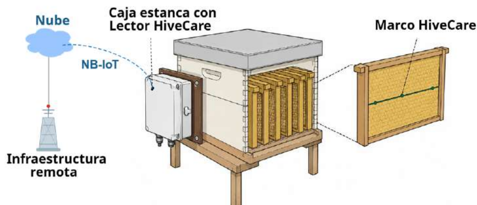
Figura D.1: Esquema simplificado de la integración del sistema HiveCare en una colmena tipo Langstroth. Se muestran los Marcos HiveCare ubicados dentro de la cámara de cría y el Lector HiveCare instalado en el exterior de la colmena dentro de una caja estanca. Además se muestra como esta manda los datos hacia la infraestructura remota. Generado con asistencia de Claude (Anthropic).
