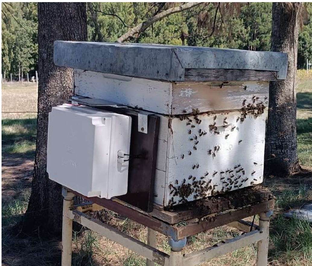
Figura 6.16: Instalación del lector en una colmena, incluyendo la caja estanca con los módulos electrónicos, el panel solar y la estructura de fijación utilizada para el montaje del dispositivo.
