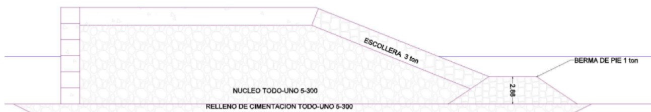
Figura 11.7: Dique de abrigo y muelle auxiliares - corte.
