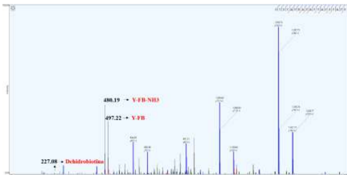
Figura 40: A) Estructuras químicas de los iones diagnósticos de m/z=497.22 (ion imonio de FB-Tyr) y de m/z=227.08 (ion dehidrobiotina). El ión de m/z 480.19 corresponde al ión imonio de FB-Tyr-NH 3 . Adaptada de Udeshi y cols. 2017 272 . B) Espectro de masa representativo de un péptido presente en la proteína SepF, que contiene residuos de Tyr modificados con FB. Se muestra la presencia de los 2 iones diagnósticos más intensos.
