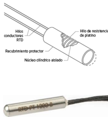
Figura 1: Esquema de la estructura de un sensor de temperatura RTD e imagen digital de un dispositivo comercial.
