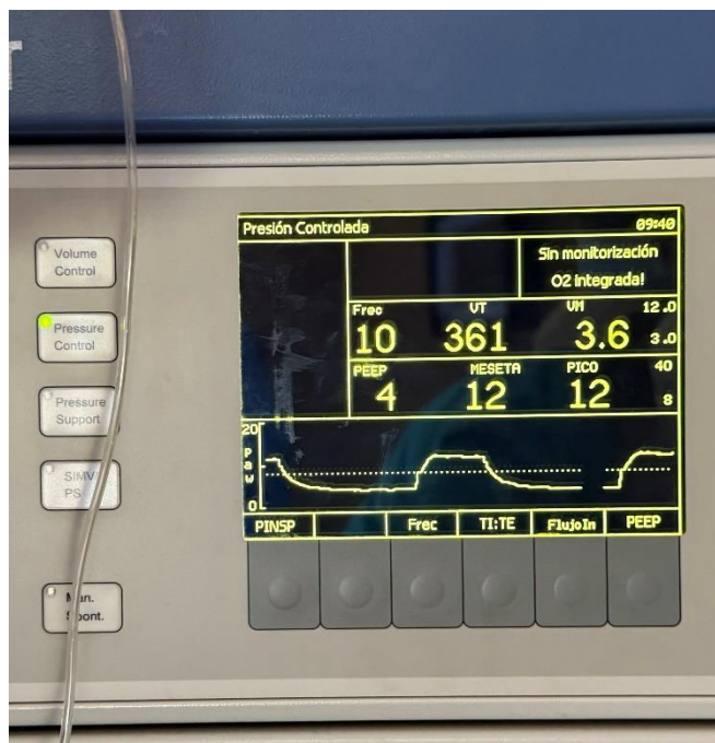
(Fig. 14) Pantalla de Ventilador de Máquina de Anestesia Dräger Fabius. Ventilación mediante presión control, con los siguientes parámetros: FR 10 rpm, VT 361 mL, VM 3,6 L/min, PEEP 4 cmH 2 O, Pplat 12 cmH 2 O, PIM 12 cmH 2 O. Debajo, curva de presión-tiempo. Archivo Personal.
