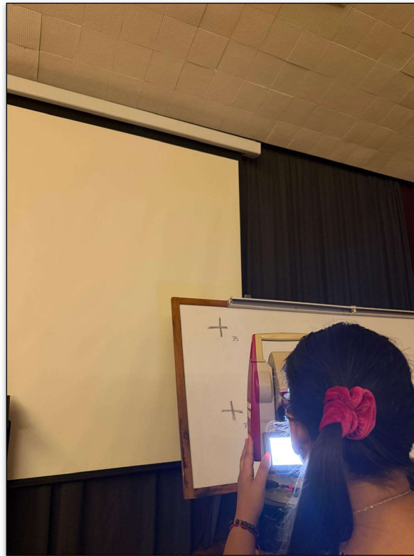
Ilustración 24: Medición con estación total de un punto previamente identificado en el modelo TLS.
