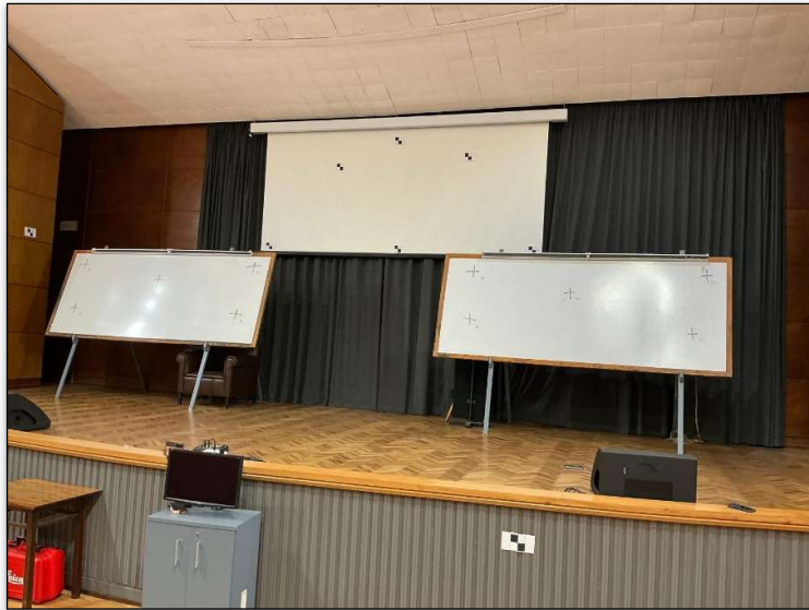
Ilustración 21: Algunas de las dianas utilizadas como punto de referencia.
