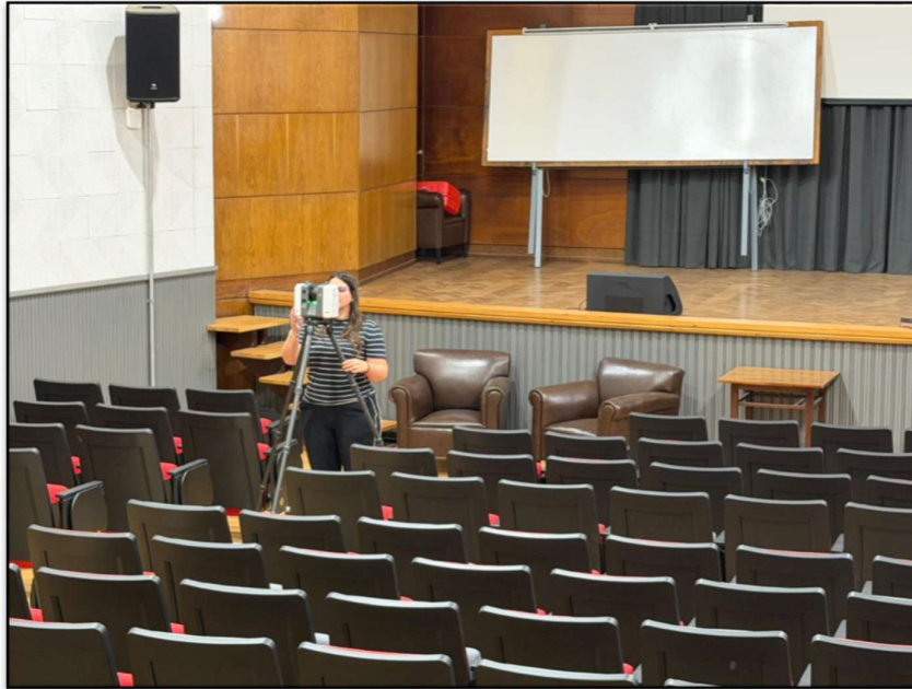
Ilustración 15: Relevamiento con TLS desde una de las cuatro estaciones utilizadas.
