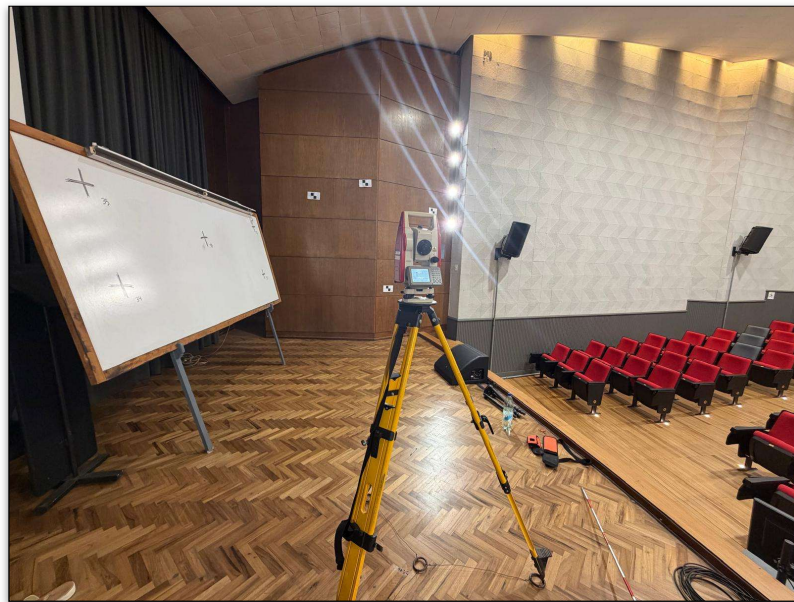
Ilustración 25: Relevamiento topográfico realizado con estación total.
