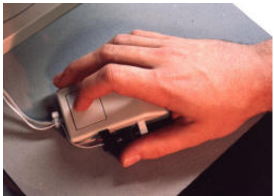
Primer mouse con scroll-wheel (Apple Computer, 1989). Contaba con una rueda en el lateral que se giraba con el dedo pulgar para desplazarse. De todas formas no se comercializó; el primer
