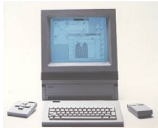
Primer computadora en contar con mouse y teclado inalámbricos (Metaphor Computer, 1984). Utilizaba señales infrarrojas para transmitir datos desde los periféricos a la computadora.
