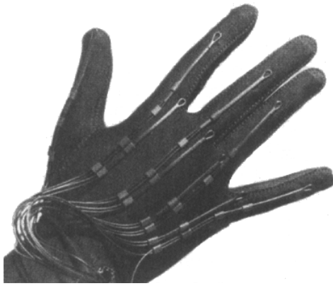
Guante óptico (Zimmerman, 1982), que surgió gracias a la introducción de un sensor óptico flexible, que fue luego incorporado a los dedos de un guante. Permitía medir el grado de curvatura del joint que cubría.
