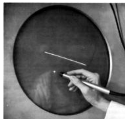
Primer lightpen (Ben Gurley, 1957), utilizado en grandes computadores mainframe , permitiendo
