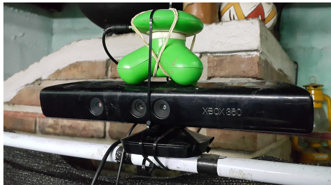
Figura 64: Sensor Microsoft Kinect para detección de usuarios y motor vibratorio en estructura
