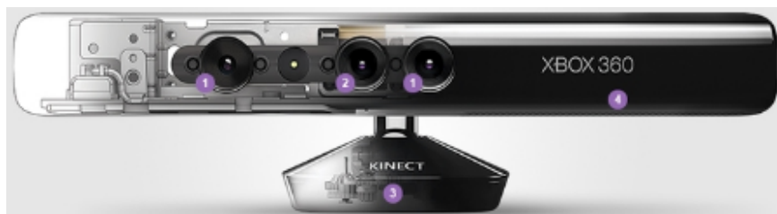
Figura 2: Componentes de Microsoft Kinect : 1- Sensor de profundidad, 2 - Cámara RGB , 3 - Motor de inclinación 4- Conjunto de micrófonos [83]
