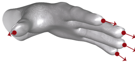
Figura 15: Vectores dirección y posición de los dedos provistos por Leap Motion [64]
