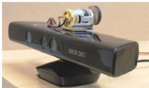
Figura 162: Motor para técnica de Vibrations [136]
