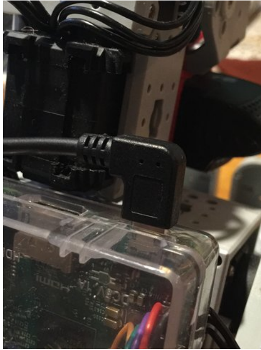
Figura 20: Cable USB en L conectado a Raspberry Pi
