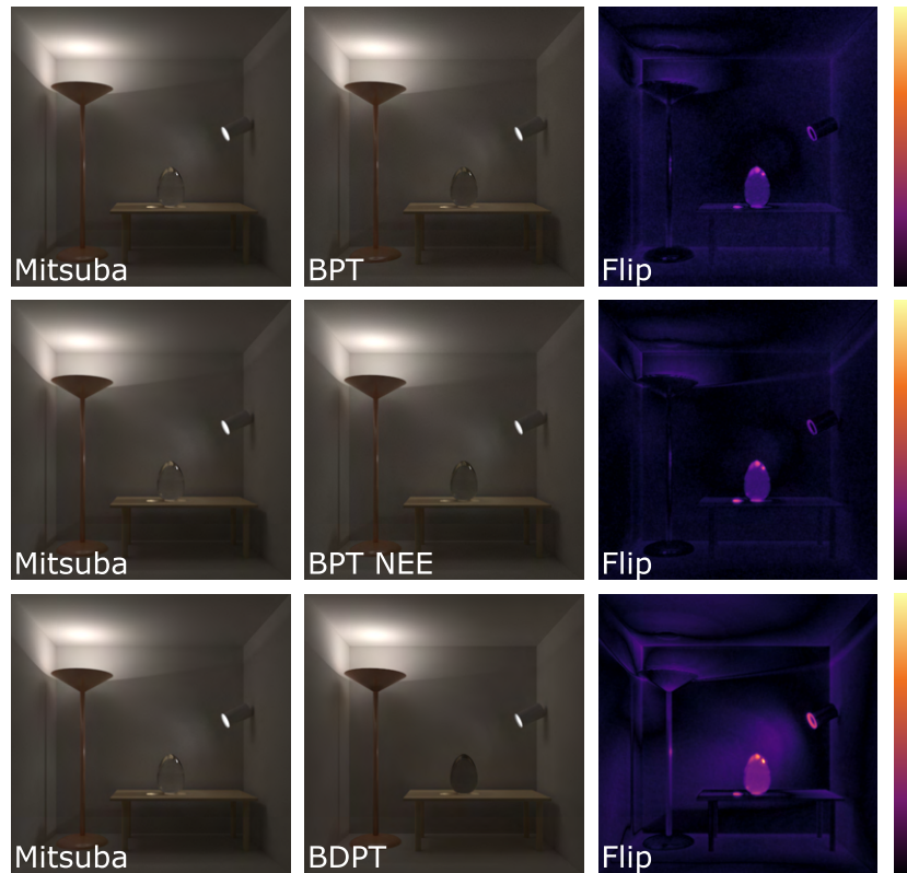
Figura 5.20: Comparación de los tres algoritmos utilizando Mitsuba como referencia. La primera columna corresponde a la referencia, la segunda a nuestra implementación y la tercera al mapa de error FLIP. Un color frío (por ejemplo, azul o violeta) indica diferencias perceptualmente poco significativas, mientras que un color cálido (por ejemplo, amarillo o naranja) indica una diferencia claramente perceptible.
