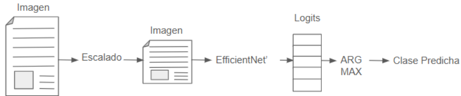
Figura 5.8: Berrutti Modelo Imágenes Multiclase. El modelo recibe como entrada una imagen procesada del documento. Esta se procesa mediante EfficientNet, obteniéndose un vector de 1.000 características. Este vector pasa por una capa lineal que produce un score para cada clase.
