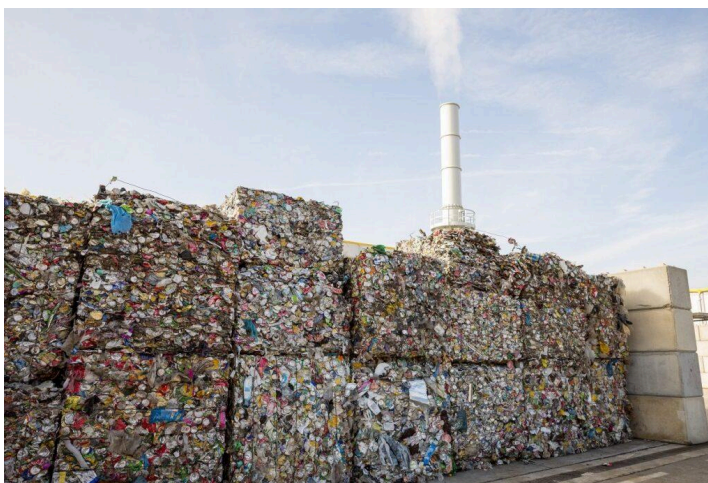
Figura 1.3: Combustible Derivado de Residuos (CDR) (Triveni Turbines, s.f.)
