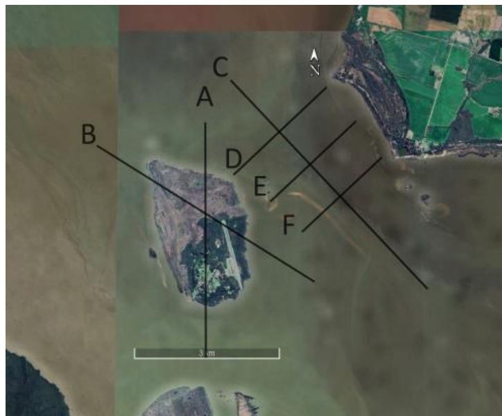
Figura 8: Representación de transectas seleccionadas para realizar los perfiles batimétricos
