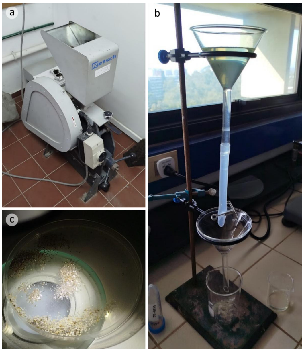
Figura 4.3.1. Parte del equipamiento utilizado en el proceso de separación mineral. (a) Trituradora de mandíbulas de acero; (b) dispositivo para decantación de minerales pesados utilizando LST y (c) lupa binocular y placa Petri para separación manual de muscovita.
