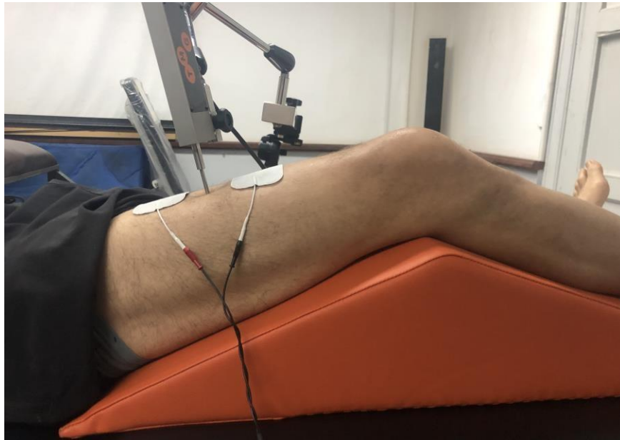
Figura 6. Colocación del dispositivo para la evaluación tensiomiográfica del músculo recto femoral.
