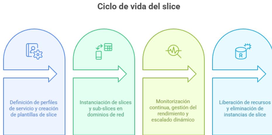
Figura 2.2: Fases del ciclo de vida de un network slice , desde su creación hasta su eliminación.
