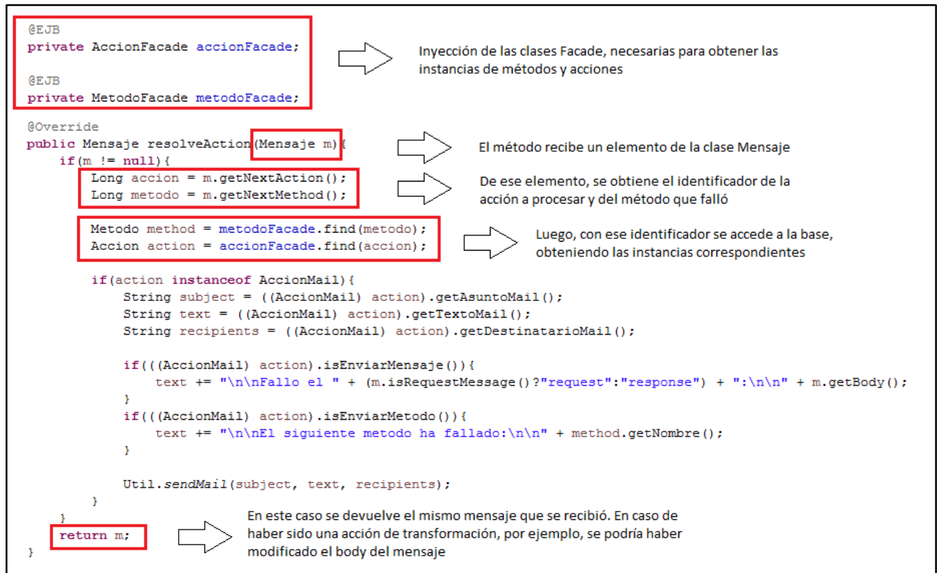
Figura A6.1. Segmento de código de la clase ActionMail , implementación del componente de ejecución de las Acciones de tipo AccionMail .
