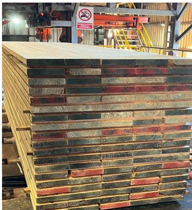
Figura 7. Tablas preparadas para el secado, diferenciadas por clases de velocidad según color.
