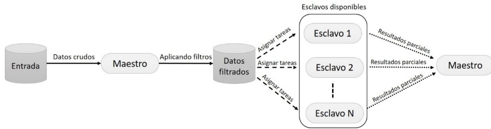
Figura 5.2: Arquitectura distribuida propuesta para el algoritmo de generación de la matriz OD.
