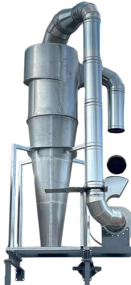
Figura 27. Estructura utilizada en ciclones. Fuente: Altef Cyclone.
