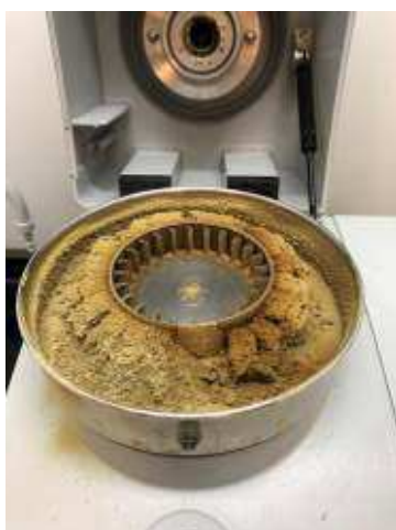
Figura 12 - Muestra quemada por sobrecalentamiento
