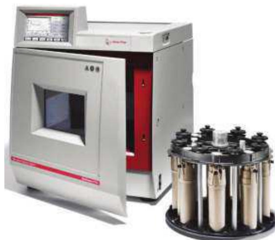
Figura 8 - Microondas de cavidad utilizado en la tesis ( Anton Paar GmbH 2019 )
