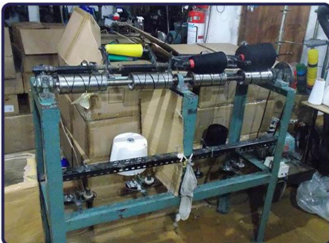
Máquina casera utilizada para encerar los conos de hilo. Parte del proceso que se realiza sobre los mismos para el buen funcionamiento de las máquinas.
