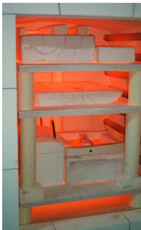
Figura 6. Moldes de casting dentro de un horno cerámico a 900 °C. Fuente. Reproducido de Sanz Lobo (2005, p. 434), El vidrio como materia escultórica: técnicas de fusión, termoformado, casting y pasta de vidrio (tesis doctoral, Universidad Complutense de Madrid).
