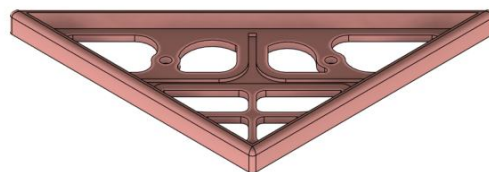
Figura 52. Esquema 3D, detalle encastre con separador Fuente: Elaboración Propia
