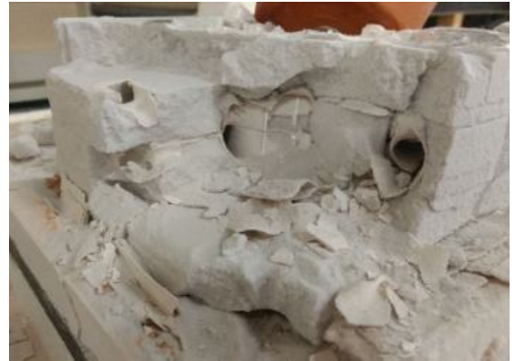
Figura 7. Molde de arena impreso colapsado tras la colada; se aprecia la delgada cáscara generada por el recubrimiento de sílice-yeso. Fuente. Adaptado de Damen et al. (2022, fig. 28), Glass Structures & Engineering . https://doi.org/10.1007/s40940-022-00181-1
