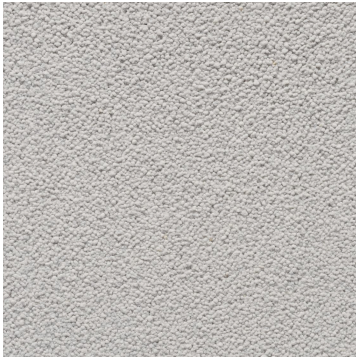
Figura 18. Detalle de Hormigón celular Fuente: Elaboración propia
