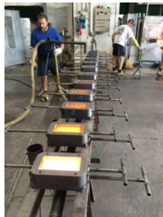
Figura 9. Enfriamiento rápido de ladrillos de vidrio fundido (de 1200 °C a ~700 °C). Fuente. Adaptado de Oikonomopoulou et al. (2017, fig. 8), Glass Structures & Engineering . https://doi.org/10.1007/s40940-017-0039-4
