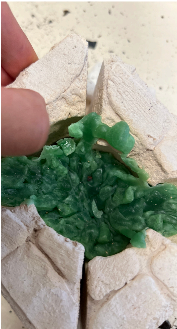
Figura 83. Fotografía, Molde luego de horneado con Positivo de molienda de Vidrio Hueco sin desmoldar Fuente: Elaboración Propia
