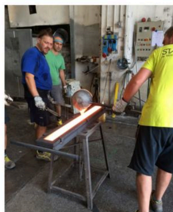
Figura 10. Vertido de vidrio fundido en un molde de grafito para fabricar marcos estructurales. Fuente. Adaptado de Oikonomopoulou et al. (2017, fig. 27), Glass Structures & Engineering . https://doi.org/10.1007/s40940-017-0039-4
