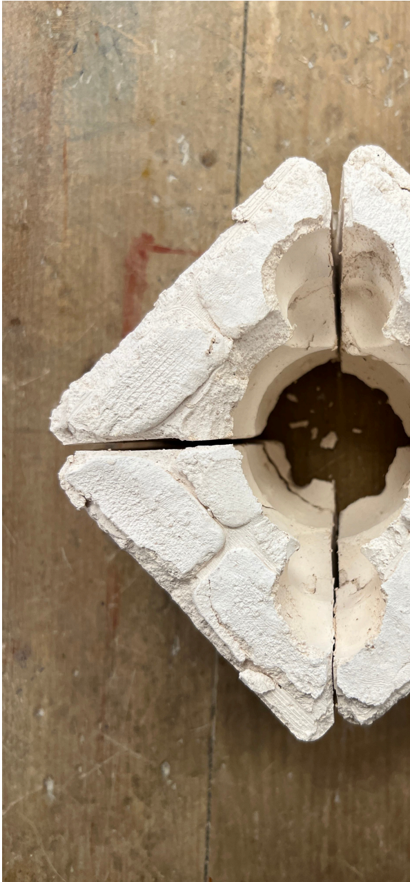
Figura 90: Molde luego de horneada de Casting y extracción del vidrio interior. Fuente: Elaboración Propia
