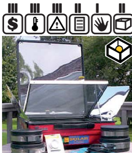
Sistema híbrido que permite utilizar la cocina con energía eléctrica como respaldo en el caso que las condiciones climáticas no sean aptas para el uso solar. Para su guardado se cierran las tapas quedando un maletín portable.
