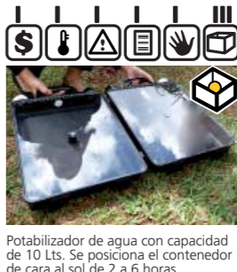
Potabilizador de agua con capacidad de 10 Lts. Se posiciona el contenedor de cara al sol de 2 a 6 horas dependiendo de las condiciones climáticas. Un indicador muestra al usuario cuando el proceso ha terminado a 65°C.
