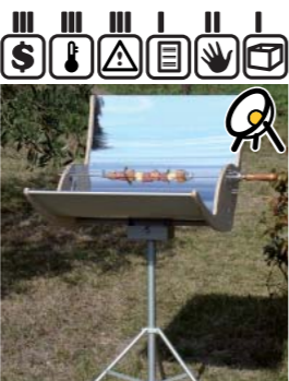
Barbacoa solar, los alimentos se colocan en el pincho que atraviesa la barbacoa y es donde se centra la radiación que capta el reflector en forma de U.
