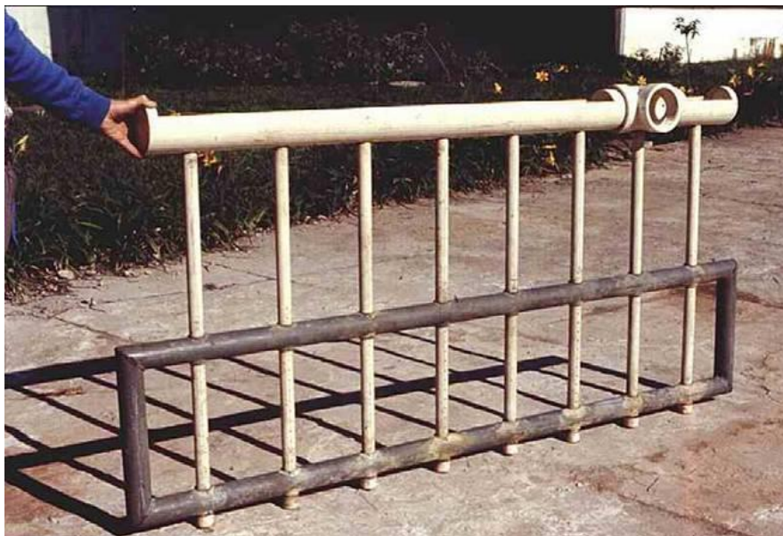
Figura 37: Imagen se dispositivo de aplicación del coagulante en el canal Parshall (fuente Ing Arboleda Valencia)
