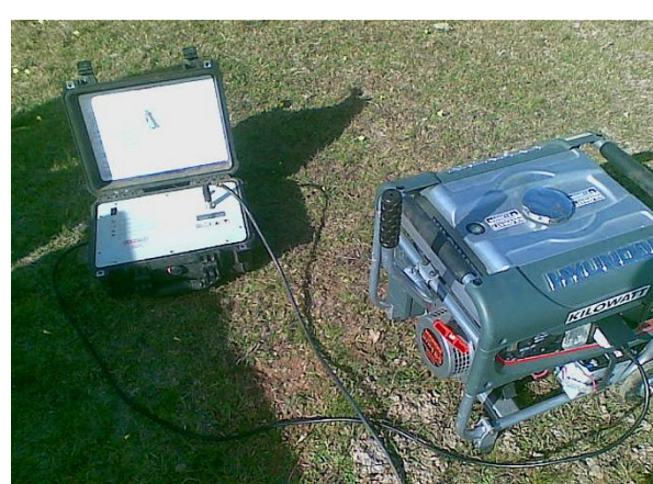
Figura 8: Controlador de la bomba y grupo electrógeno (fuente: producción propia)
