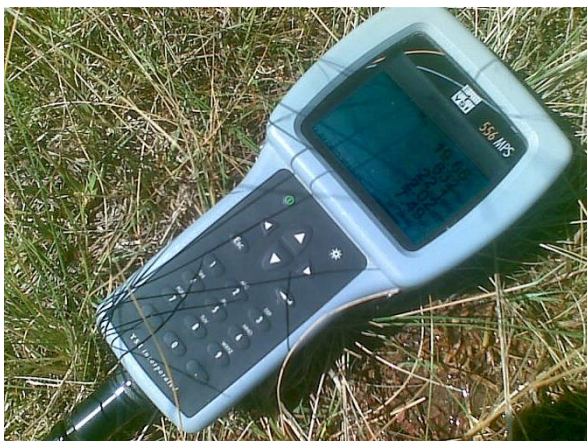
Figura 5: Instrumento de la sonda multiparamétrica reportando lecturas (fuente: producción propia)
