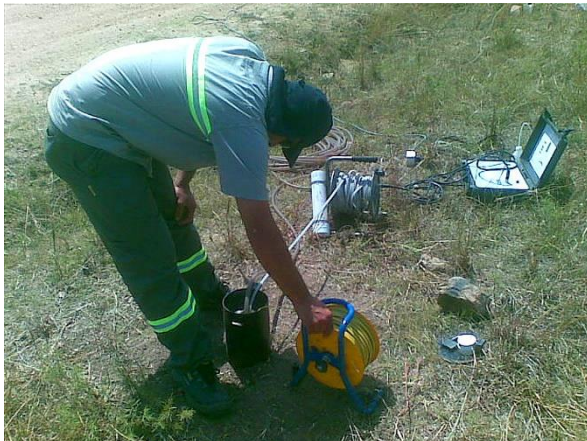
Figura 4: Medición del descenso del nivel de agua durante el bombeo (fuente: producción propia)
