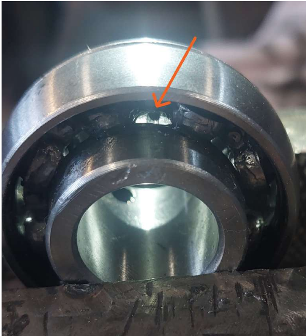
Figura 74. Rodamiento con daño en la pista interna (Prueba 2).
