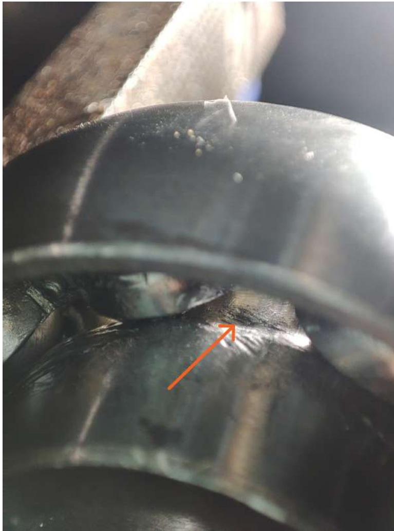
Figura 79. Rodamiento con daño en la pista interna (Prueba 3).
