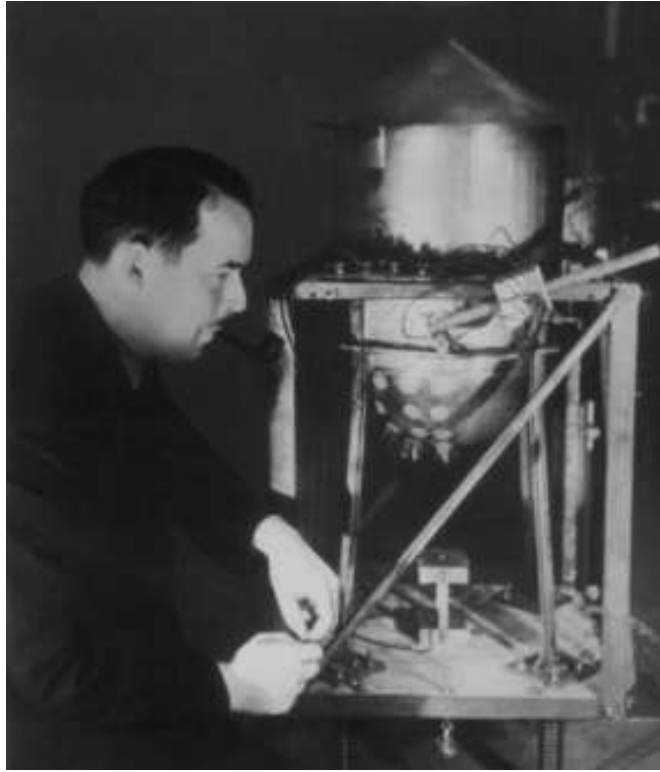
Figura 4. A. C. Ruge realizando experimentos en un modelo a pequeña escala de un tanque de agua equipado con las primeras galgas extensiométricas montadas en una mesa vibratoria en 1938. [31]
