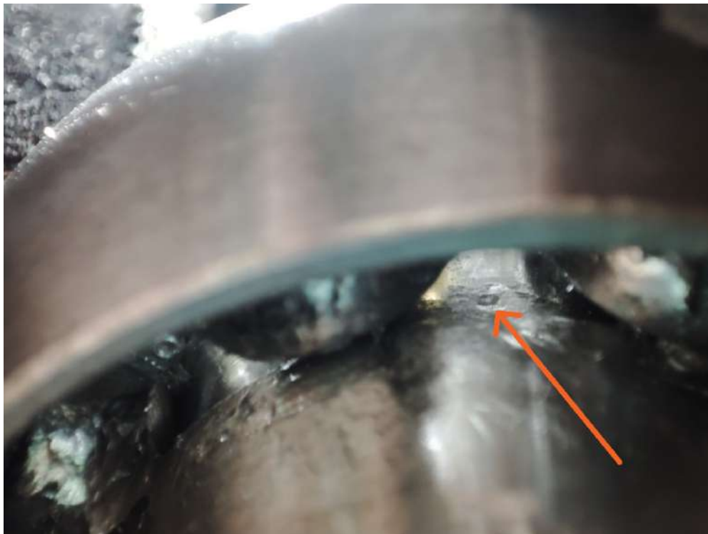
Figura 65. Rodamiento con daño en la pista interna (Prueba 1).
