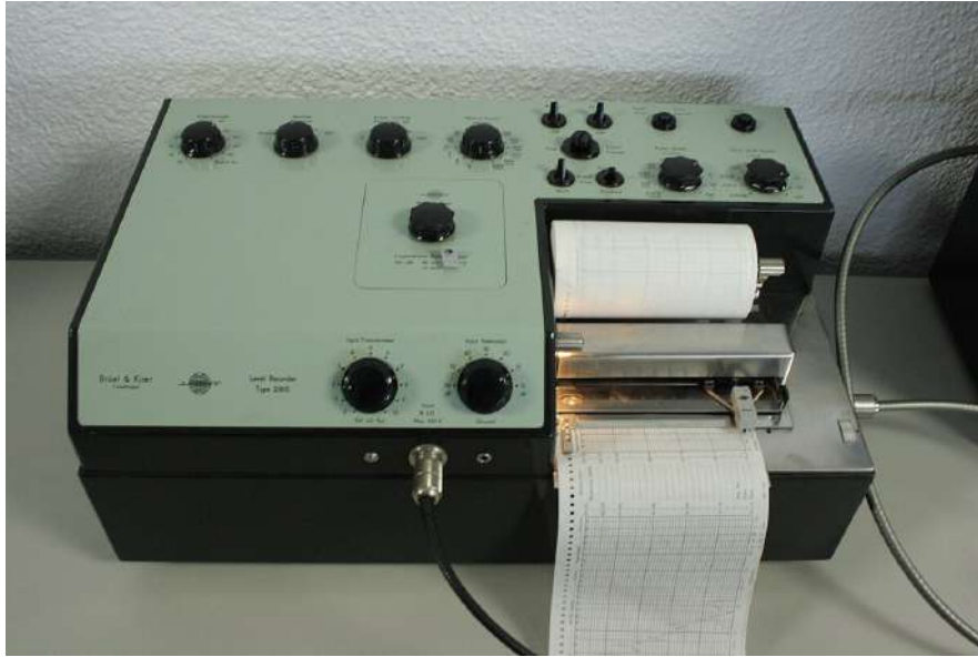
Figura 15. Registrador gráfico analógico Brüel y Kjær Level Recorder Type 2305 utilizado para medición y registro continuo de niveles de vibración, sonido y señales eléctricas. [33]
