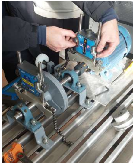
Figura 58. Alineación del banco con alineador TKSA 41 de SKF.
