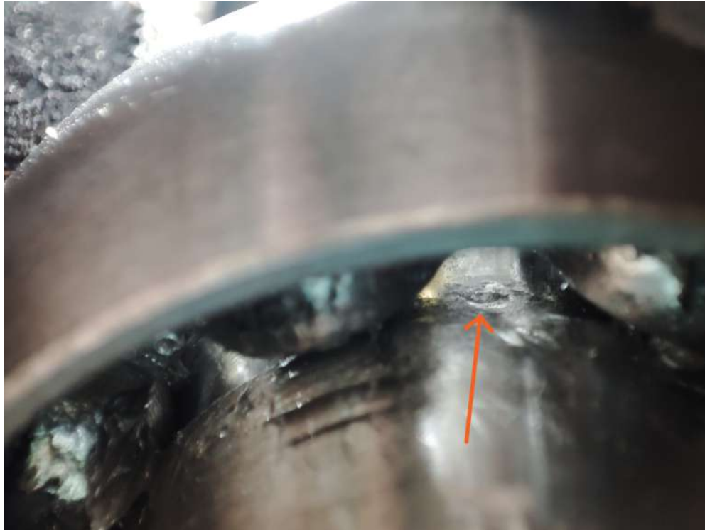
Figura 83. Rodamiento con daño en la pista interna (Prueba 4).
