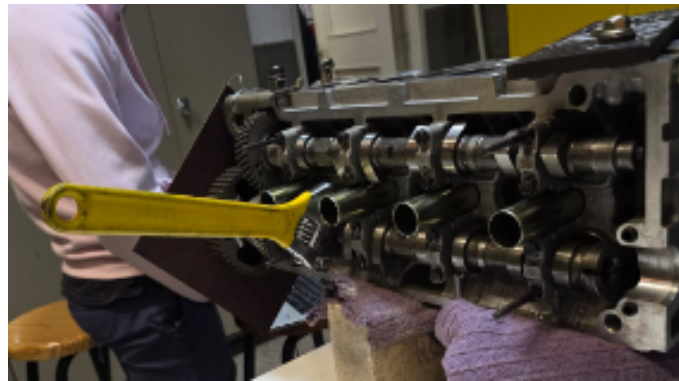
Figura 4.4: Medición del lift de válvula. Elaboración propia.
