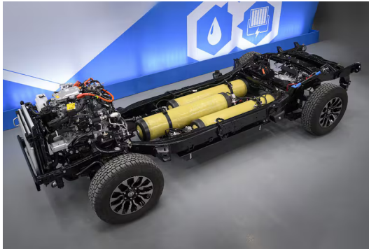
((a)) Almacenamiento de hidrógeno en los prototipos de la Toyota Hilux.
