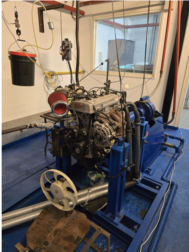
Figura 4.12: Estado del motor Geely MR479Q una vez finalizado el armado. Elaboración propia.
