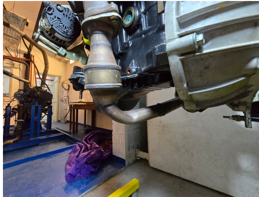
Figura A.4: Daños al caño de escape surgidos del test crash. Elaboración propia.
