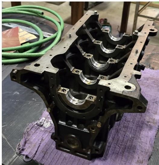
Figura A.7: Bloque de motor desarmado. Elaboración propia.
