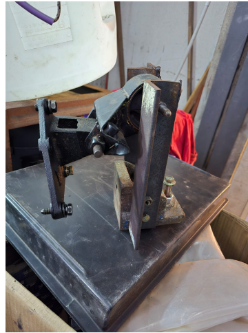
Figura A.12: Pieza metálica ensamblada para montar el motor Geely. Puede visualizarse el asiento del motor. Elaboración propia.
