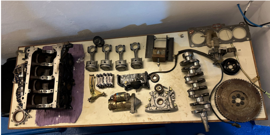
Figura A.6: Motor completamente desarmado. Elaboración propia.
