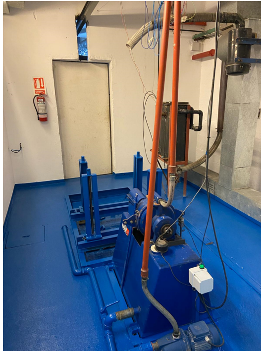
Figura 3.8: Banco de ensayos de motores del laboratorio del IIMPI. Se observa el freno hidráulico, con su batea y bomba para la recuperación del agua, además de un radiador sumergido para la refrigeración del motor. Elaboración propia.
