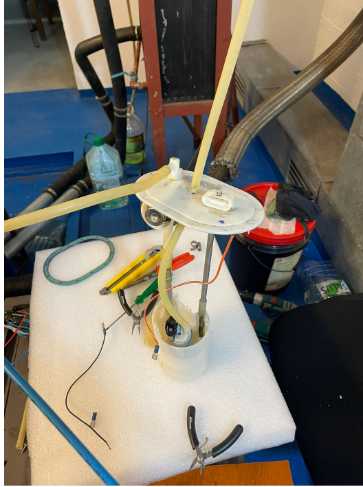
Figura A.20: Modificación de la tapa de combustible para soportar mayores presiones. Elaboración propia.
