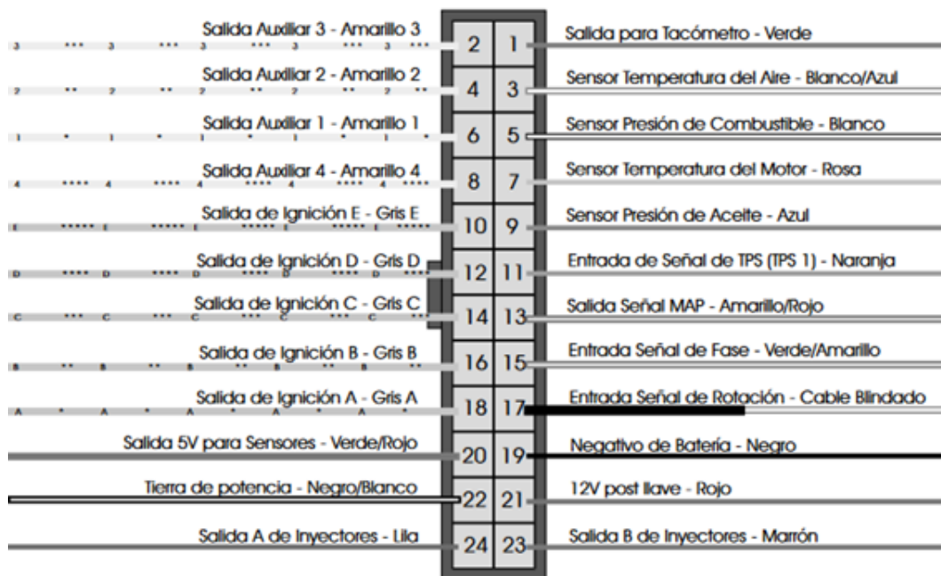
Figura A.23: Arnés posterior principal de Fueltech con sus funciones. Fuente: Fueltech, 2017.
