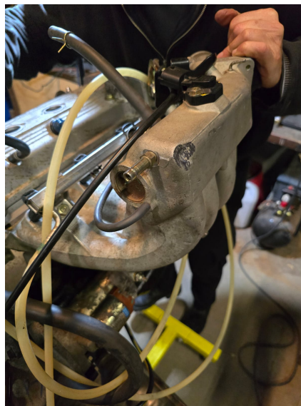
Figura A.5: Daños al intake manifold surgidos del test crash. Elaboración propia.
