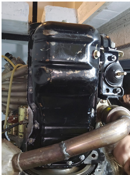
Figura A.3: Daños al cárter surgidos del test crash. Elaboración propia.
