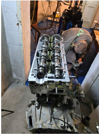
Figura A.10: Tapa de cilindro instalada. Se pueden apreciar los dos árbol de levas. Elaboración propia.
