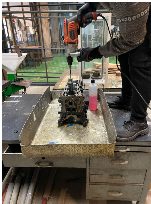
Figura A.8: Bloque de motor en pleno proceso de bruñido. Elaboración propia.
