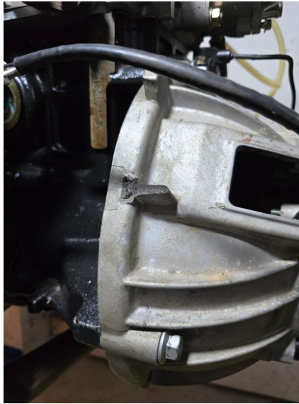
Figura A.2: Daños en la caja de cambios surgidos del test crash. Elaboración propia.
