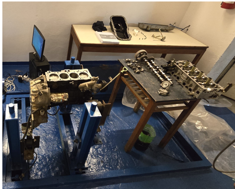
Figura 4.11: Estado del motor Geely MR479Q previo al comienzo del desarmado. Elaboración propia.
