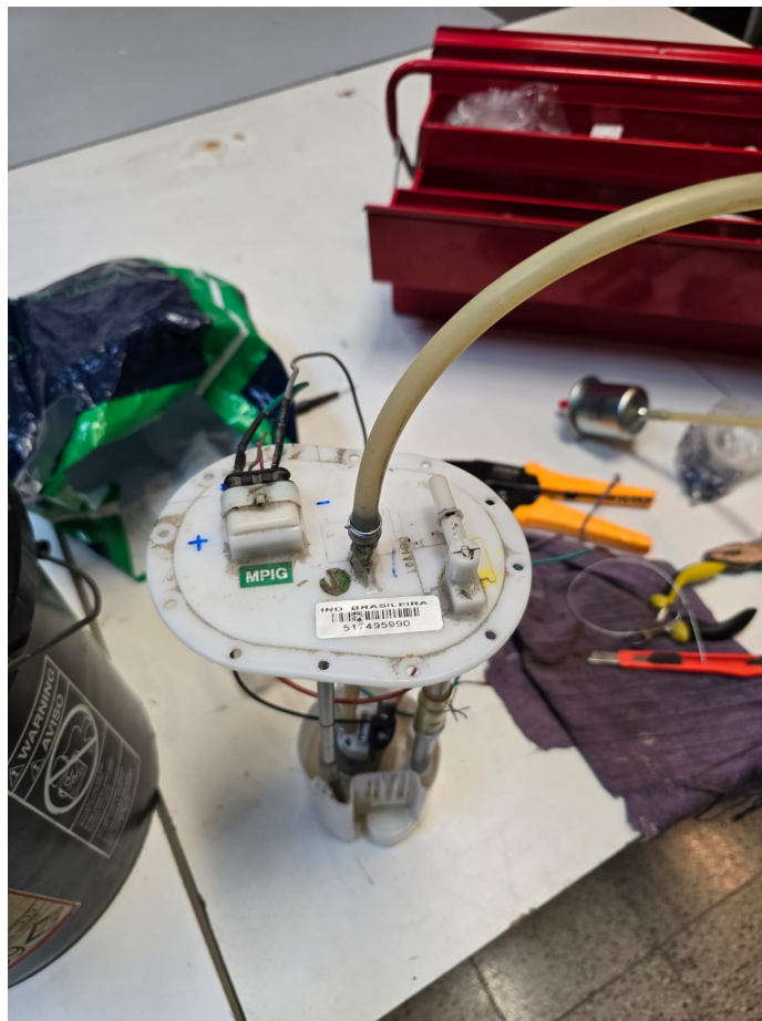
Figura A.19: Modificación de la tapa de combustible realizada por terceros. Elaboración propia.
