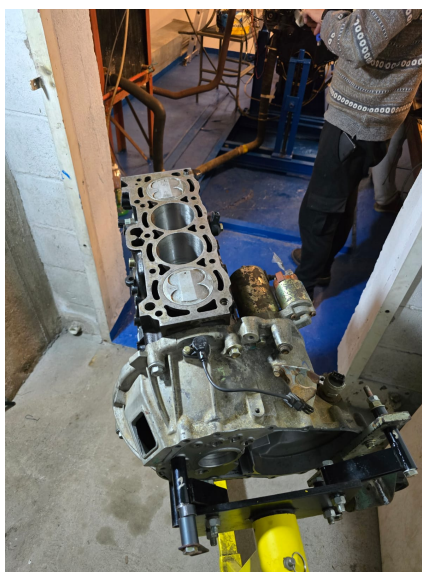
Figura A.9: Bloque de motor armado, con pistones colocados. Elaboración propia.
