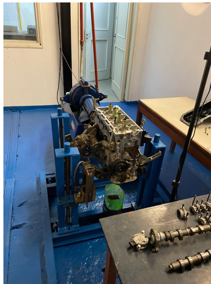
Figura A.13: Motor parcialmente instalado en el banco. Se puede apreciar la pieza metálica utilizada para montar el motor. Elaboración propia.
