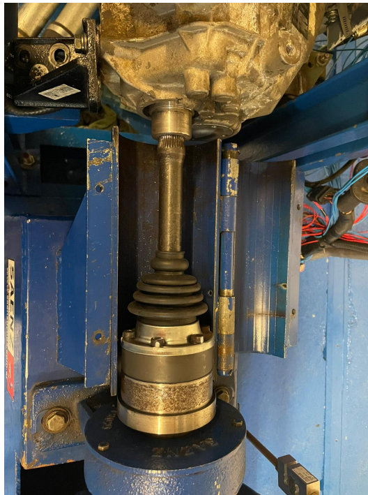
Figura A.32: Vista del semieje del banco. Elaboración propia
