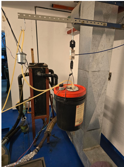
Figura A.21: Sistema de suministro de combustible instalado a celda de carga. Elaboración propia.
