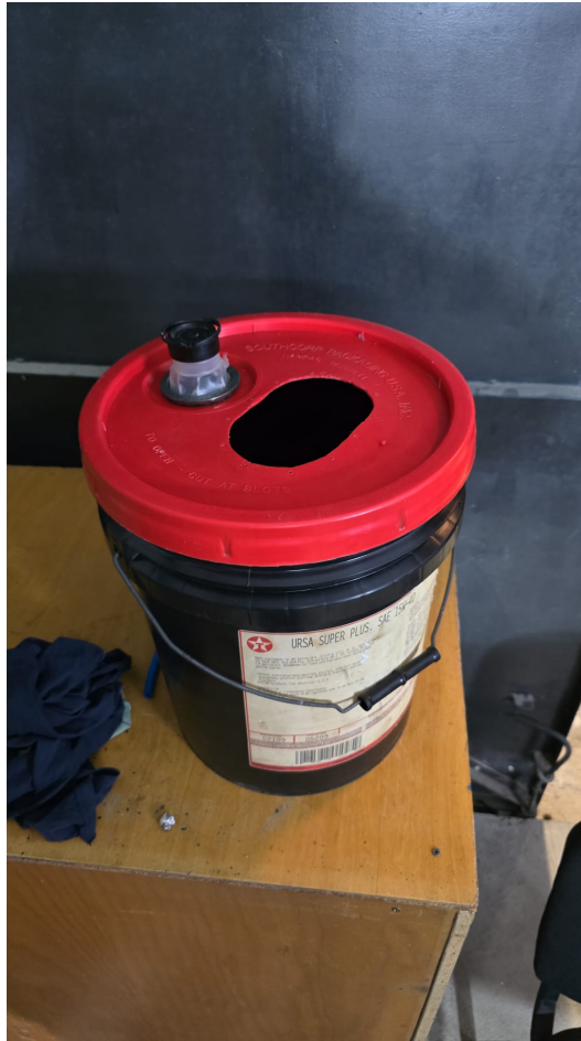
Figura A.18: Balde de aceite reutilizado como tanque de combustible. Elaboración propia.
