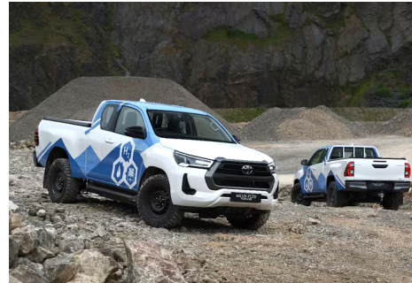
((b)) Prototipo de la Toyota Hilux con pilas de combustible a hidrógeno (FCEV).
