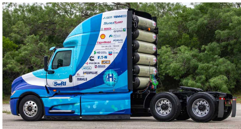
Figura 2.3: Camión con motor de combustión de hidrógeno diseñado por SwRI. Fuente: Southwest Research Institute, s.f.-a .
