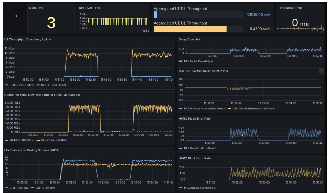
Figura 6.6: Parte del panel de Grafana de la xApp de monitoreo con todo el sistema activo transmitiendo del UE al core.
