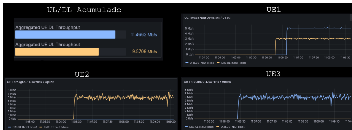
Figura 6.8: Estadísticas de tráfico para cada nodo junto al acumulado. En azul el downlink y en amarillo el uplink .
