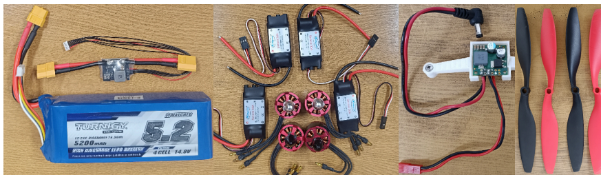
Figura 2.4: Componentes que conforman la alimentación y propulsión del Dron.
