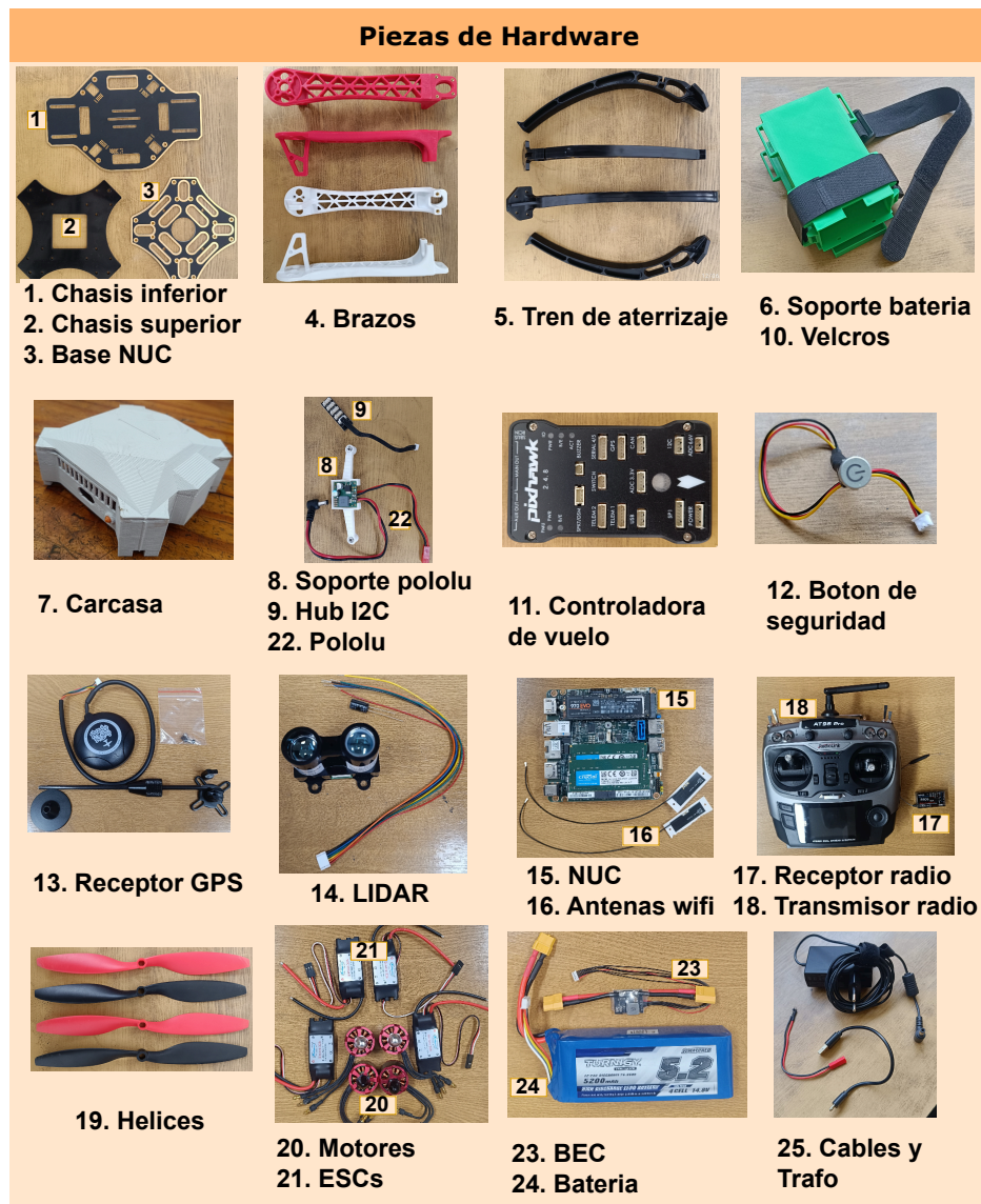
Figura 2.6: Guía visual de la totalidad de las piezas del dron.
