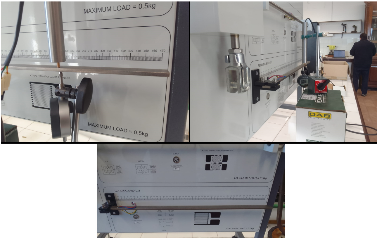
Figura 4.16: Ensayo en barra de acero en voladizo, con LVDT-IIIE y un comparador analógico NEOteck
