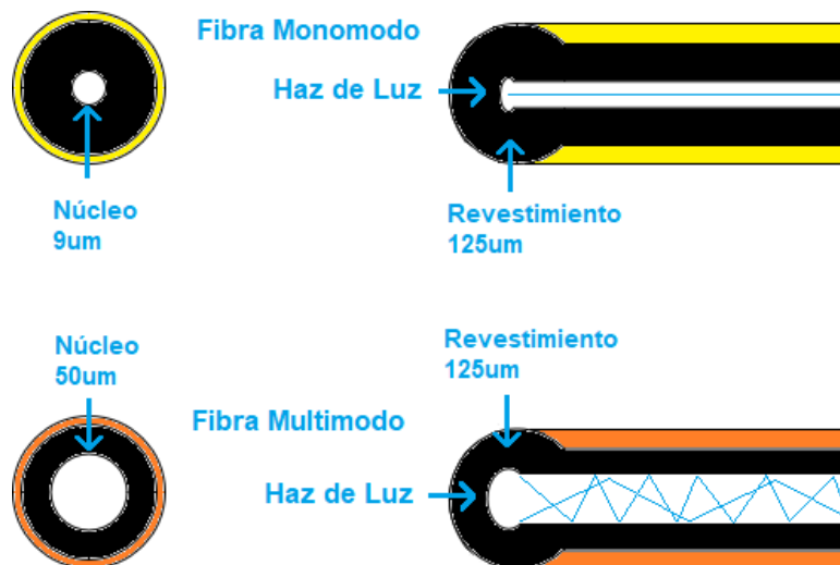
Figura 1.3: Tipos de fibra óptica: Unimodal (arriba), Multimodal (abajo) [27]
