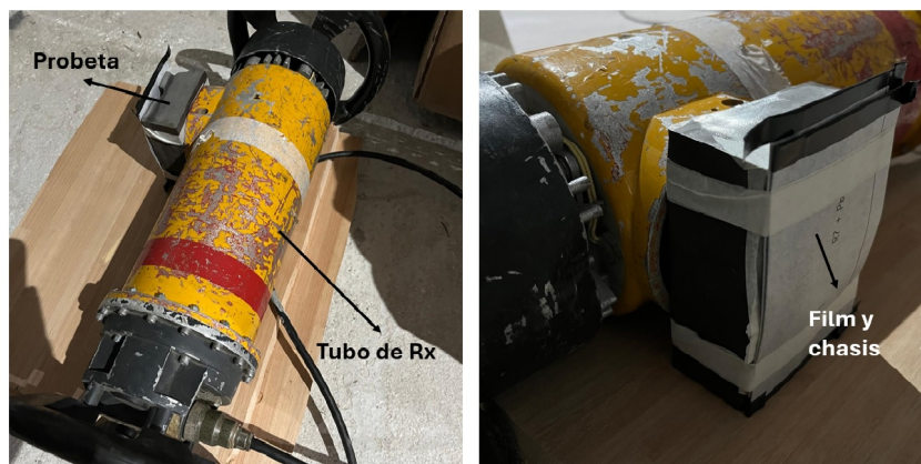
Figura 3.12: Montaje para ensayo de Rx.
