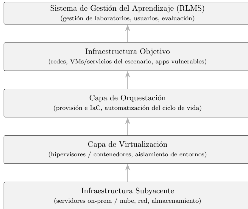
Figura 2.1: Arquitectura por capas de un cyber range (adaptado de NIST, The Cyber Range: A Guide , 2023).
