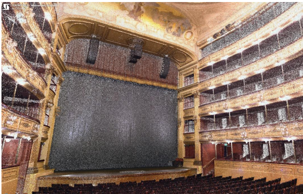
Figura 47: Nube de puntos del Teatro Solís. Fuente: Centro de Información Digital - Facultad de Arquitectura.
