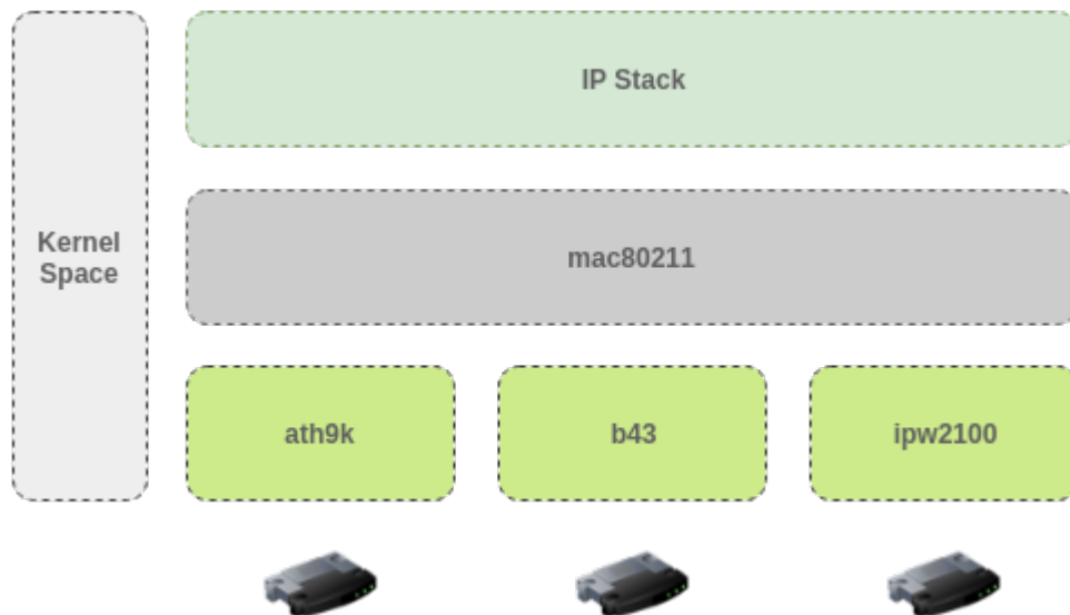
Figura 4.1: Diagrama de la arquitectura de ath9k .
