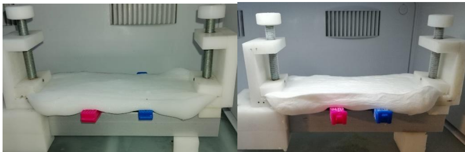
Figura 28. Fantoma anisotrópico en base a PVA y celulosa como difusor de ultrasonido. El PVA es un hidrogel el cual se polimeriza mediante ciclos de congelado y descongelado. Para generar la anisotropía, previo a cada ciclo de congelado el fantoma es sometido a un estiramiento.
