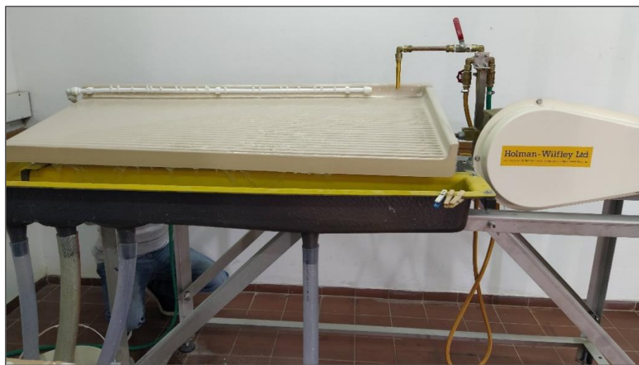
Figura 11: Mesa vibratoria utilizada para la separación por gravedad de minerales densos.
