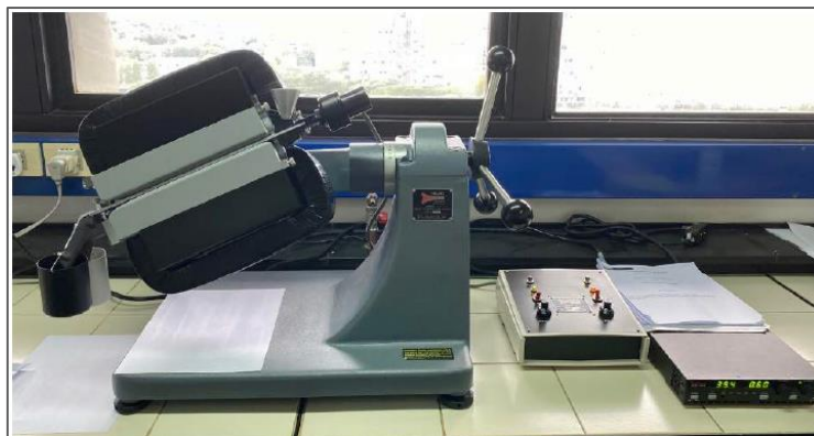
Figura 12: Separador isodinámico Frantz utilizado en la separación de minerales (Testoni, 2020).
