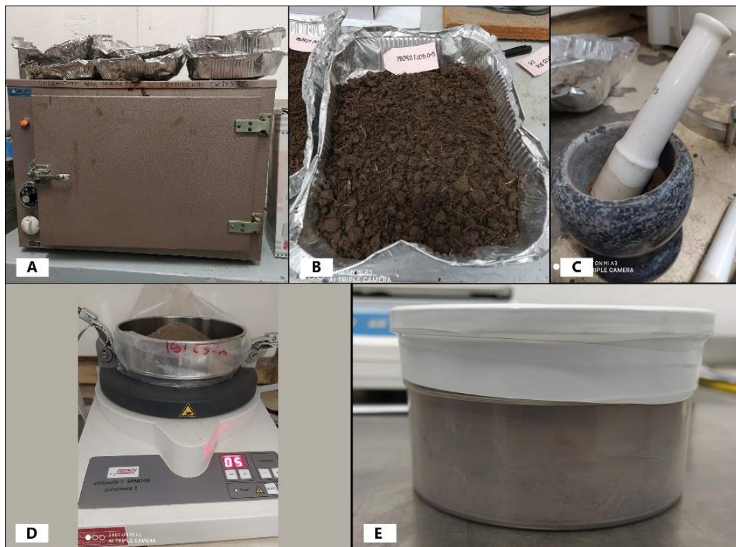
Figura 6: Fotografías del procesamiento de muestras de suelo. (A, B) Secado de muestras; (C) Desagregado de la muestra; (D) Tamizadora vibratoria; (E) Muestra sellada en un recipiente Marinelli.
