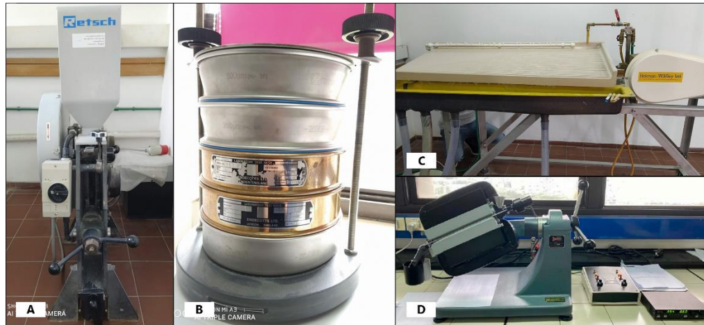
Figura 7: Fotografías del procesamiento para la obtención de concentrados de minerales densos. (A) Trituradora de mandíbula; (B) Tamizadora vibratoria; (C) Mesa vibratoria Wilfley; (D) Separador magnético Frantz, tomado de Testoni (2020).
