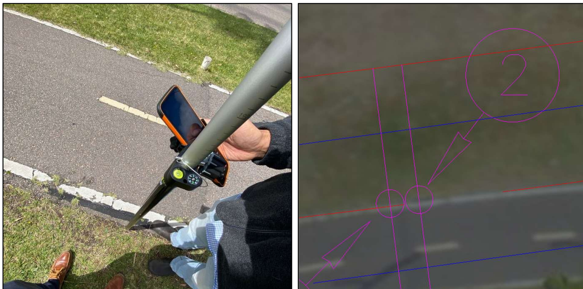
Figura N° 56. Punto N°2 de replanteo en terreno (izquierda) y proyectado sobre ortoimágen (derecha). Fuente: Elaboración propia.
