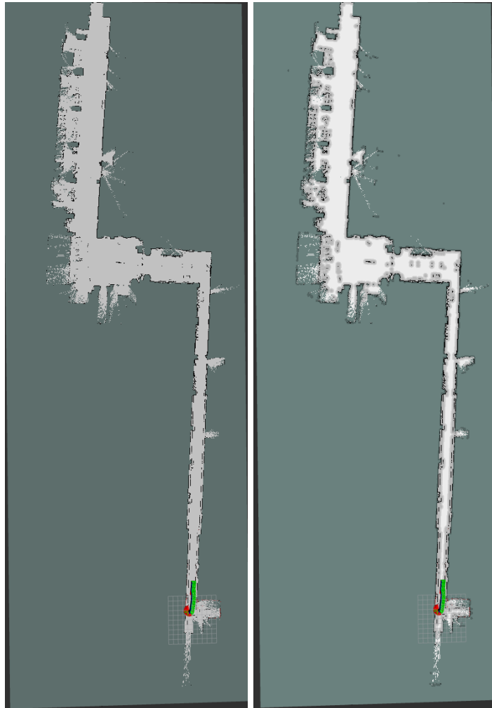
Visualización de Mapa y mapa de costos con odometría basada en LiDAR, del primer piso
