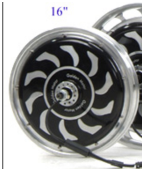
Figura 4.2: Rueda de 16 pulgadas de rodado del kit ‘Magic Pie’ de Golden Motor
