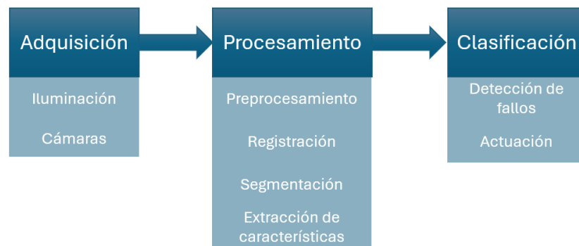
Figura 2.1: Arquitectura típica de AOI
