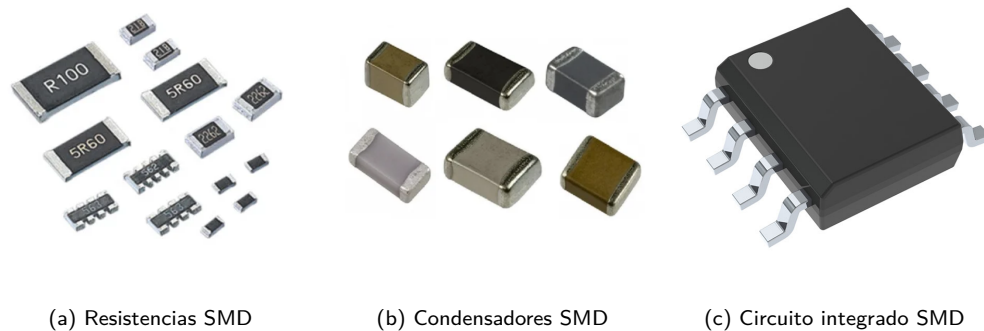
Figura 1.3: Ejemplos de componentes SMD
