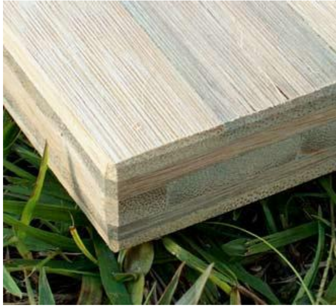
Figura 3: Tablero compuesto por varias capas de guadua prensada. (Bambumex, 2011)
