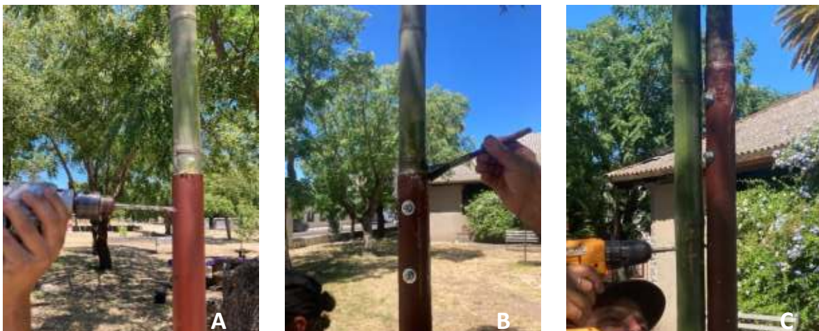
Figura 27 – Dispositivo de unión 8. a) Detalle de perforación de pieza metálica y culmo, b) Detalle de colocación de fibra de vidrio, c) Dispositivo terminado.
