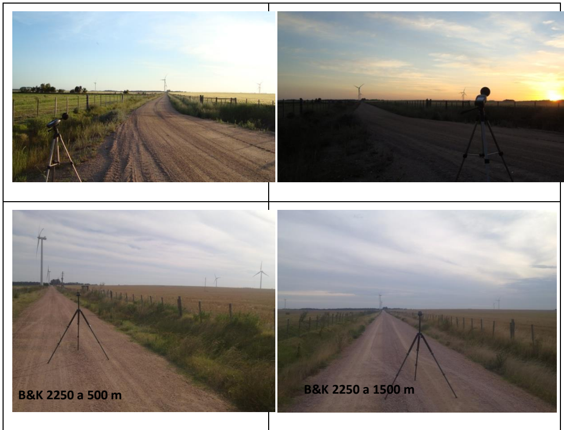
Figura 9.5 Mediciones puntuales a distintas distancias.
