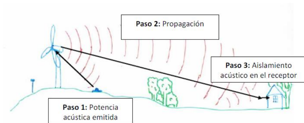
Figura 6.1. Pasos en la predicción de niveles sonoros en inmisión
