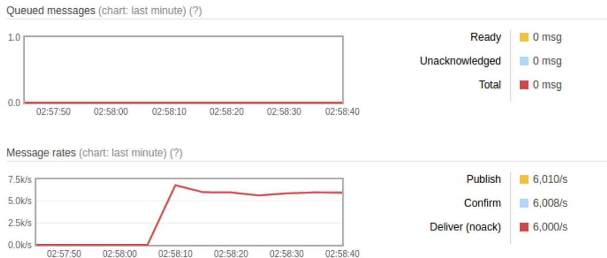
Figura M.12 - Captura de pantalla del sitio de Gestión de RabbitMQ mostrando el estado de la cola durante la ejecución de la prueba con 200 clientes.
