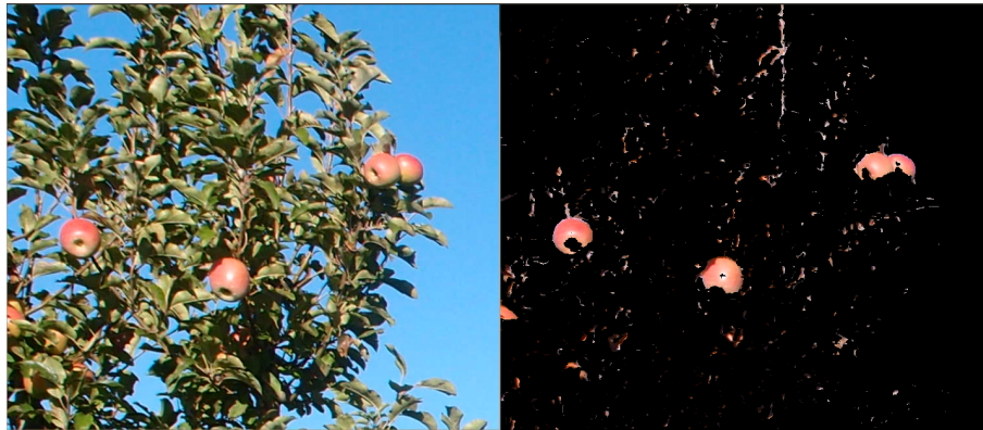
Figura 3.4: Ejemplo de segmentación usando H. A la izquierda se encuentra la imagen de la base de datos, a la derecha la imagen luego de realizar segmentación según H.
