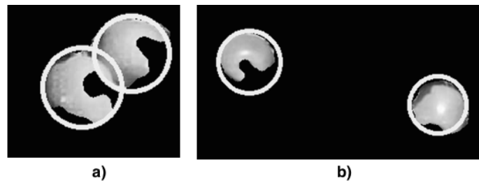
Figura 2.26: Ejemplo detección de círculos. a) Círculos en conjunto de manzanas, b) Círculos en manzanas incompletas
