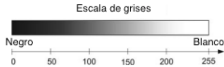
Figura 2.7: Escala de grises. La relación entre el valor numérico y las distintas tonalidades de gris.
