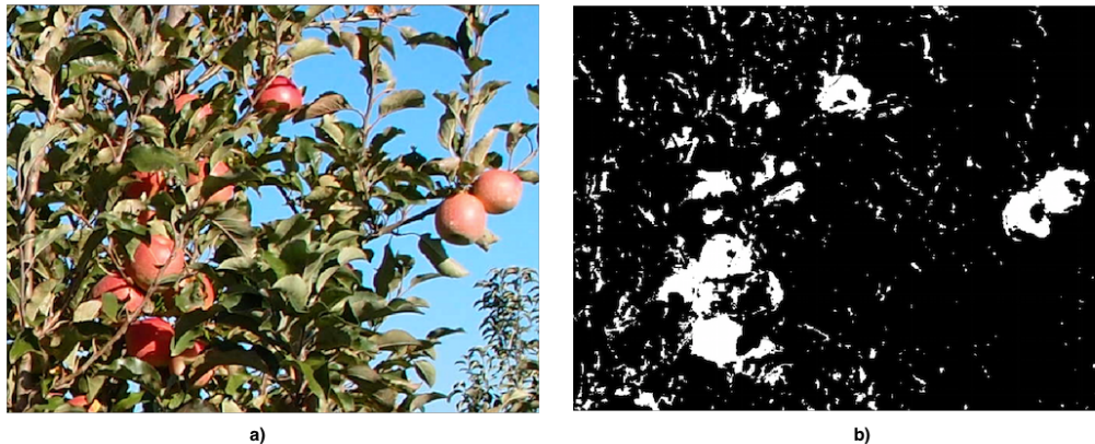
Figura 3.11: a) Imagen original b) imagen resultado de aplicar reconocimiento de píxeles. Allí se puede notar regiones con áreas de tamaño apreciable y contiguas, y otras más pequeñas y aisladas, ruido.
