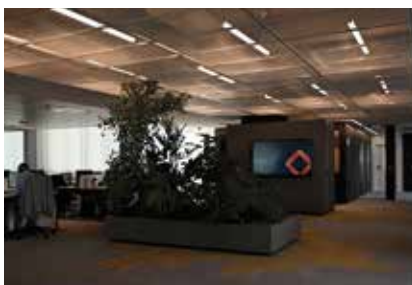
Figura 2. Diseño de iluminación versátil para oficinas. Espacios confortables y adaptables a los ciclos biológicos de los usuarios, mediante la variación de la temperatura de color entre 2700 K y 6500 K, con regulación del flujo luminoso y un índice de reproducción cromática (CRI) constante.
