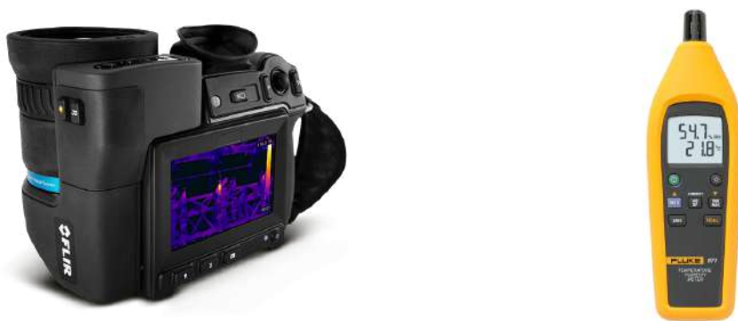
Figura 4.3: Instrumentos utilizados en la adquisición de datos: (izquierda) cámara FLIR T1020 (fuente: Teledyne FLIR), (derecha) termómetro FLUKE 971 (fuente: Fluke).
