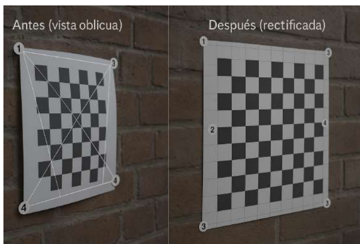
Figura 3.5: Ejemplo de Homografía. En la imagen de la izquierda (Antes) se observan los cuatro puntos numerados (1-4) que marcan las esquinas del tablero, conectados por segmentos que ilustran la relación geométrica original en una vista oblicua. Estos puntos definen las correspondencias utilizadas para calcular la matriz de homografía, la cual transforma el plano inclinado en un plano frontal. En la imagen de la derecha (Después), el patrón aparece rectificado: las líneas se vuelven ortogonales y el tablero recupera su forma cuadrada.
