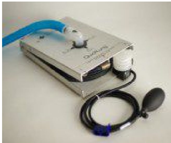
Figura 23 - QuickTrigger. En la imagen se puede apreciar un dispositivo QuickTrigger colocado en un QuickLung. Tomado de IngMar Medical [47]
