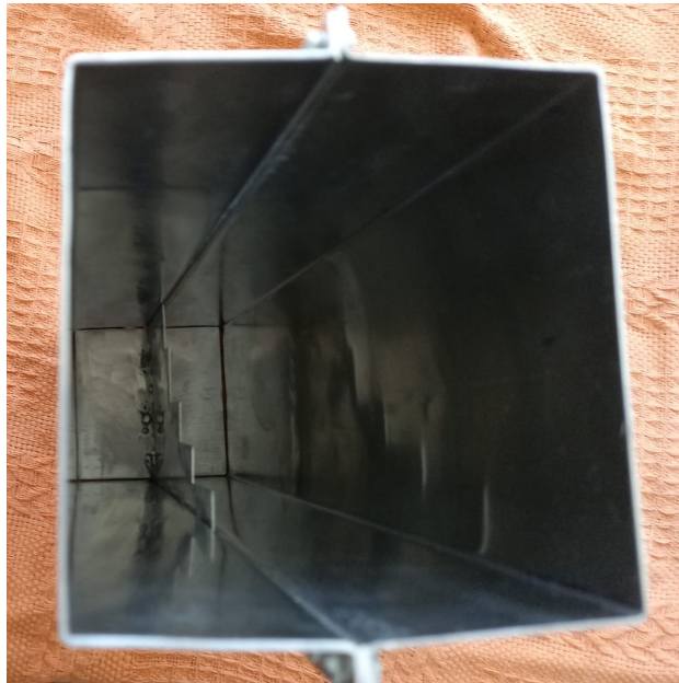
Figura 6.10: Vista frontal de la primera versión del septum feed construido.
