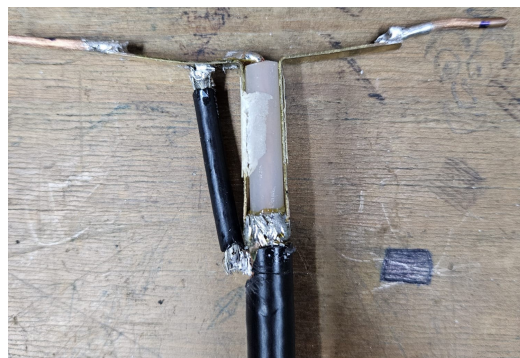
Figura 5.5: Dipolo utilizado para el sistema de recepción de HRIT, adaptado en frecuencia y con balun.
