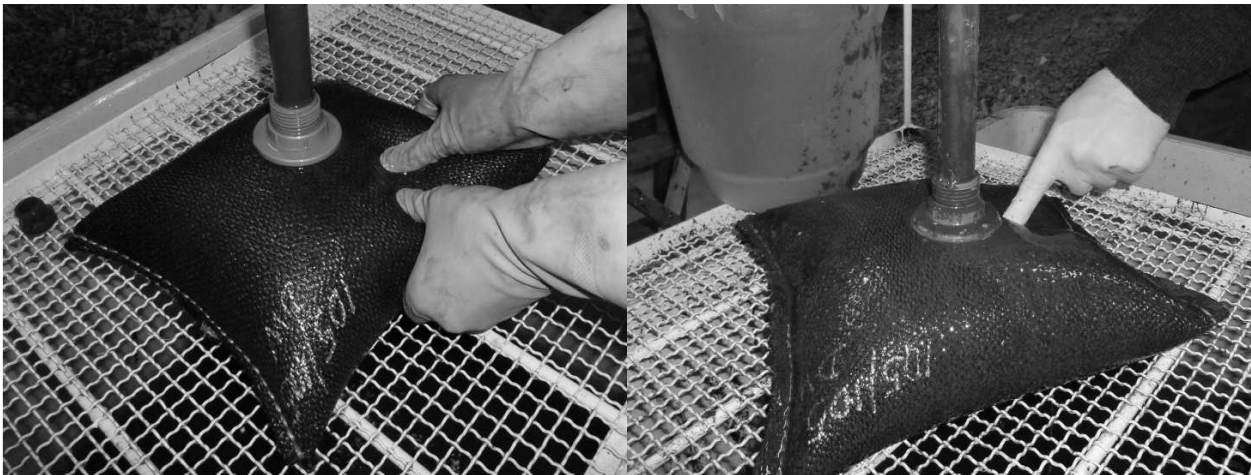
Figura 3.- Izquierda: almohadilla que ha siendo rellena con barro con la dosis óptima de polímero. No se observa escape de material luego que la torta de filtrado se ha formado, incluso presionando firmemente la almohadilla con los dedos. Derecha: almohadilla que ha siendo rellena con barro con una dosis insuficiente de polímero. Se observa claramente la perdida de material a través del geotextil y de las costuras. Notese que en el geotextil es el mismo, destacando la importancia de utilizar la dosificación adecuada de polímero, más allá de las características del geotextil.
