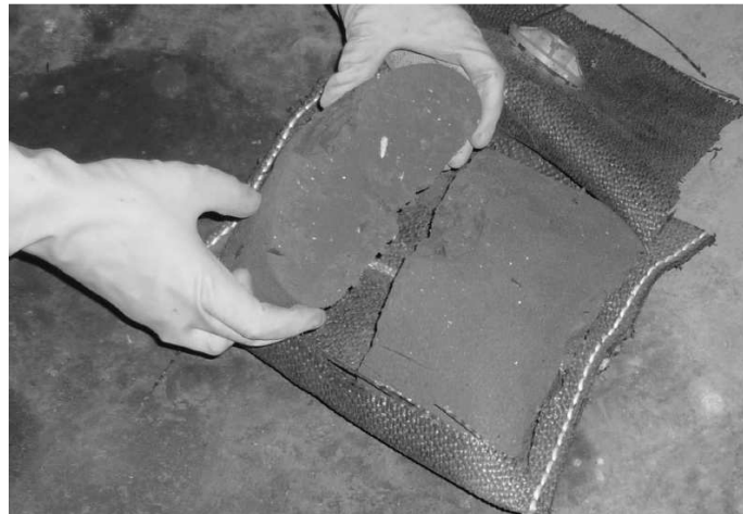
Figura 4.- Barro seco luego de más de un mes en la almohadilla. El material tiene el aspecto de un suelo arcilloso y no se desagrega al sumergirlo bajo agua.
