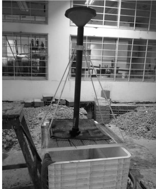
Figura 2.- Configuración experimental utilizada para el llenado de las almohadillas. El tubo vertical tiene 1 m de alto. La almohadilla se apoya sobre una rejilla, permitiendo la descarga del agua por toda la superficie de la almohadilla. El agua es recolectada en el tanque inferior.
