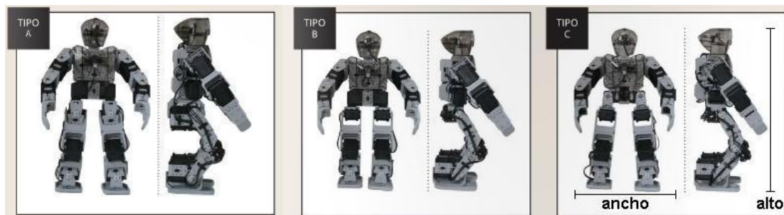
Figura 2.3: Tipos de robots humanoides Bioloid (dimensiones: 24 cm de ancho y 38 cm de alto).
